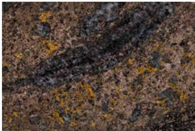
Nikkel (brunt mineral) og koppersulfider (gullaktig mineral) fra Ringerike. Lengden på fotografiet er ca 6 cm.
