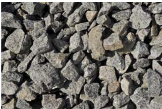
Pukk er knust fjell. Det er slett ikke alt fjell som er egnet til pukkproduksjon, men i brukbare forekomster består utvinningen i å sprengne ut fjellet, knuse det ned og sortere partiklene etter størrelse før salg til konsument.
